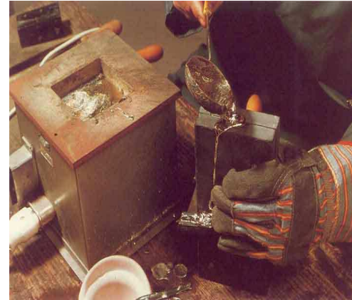
gieten van een tinnen figuur met vloeibaar tin
