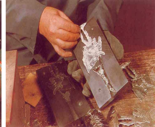
tinnen figuur uit de gietmal halen
