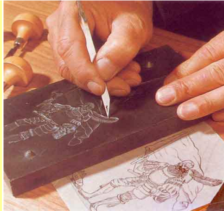
graveren van een gietmal naar het voorbeeld van een tekening
